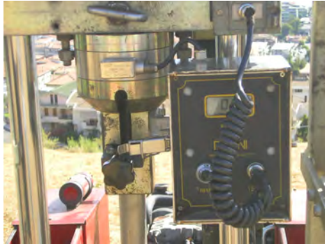
Centralina elettronica digitale con cui sono state registrate le misure di resistenza
