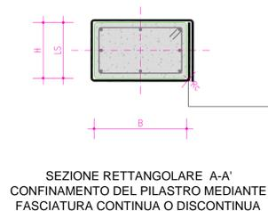
SEZIONE RETTANGOLARE A-A' CONFINAMENTO DEL PILASTRO MEDIANTE FASCIATURA CONTINUA O DISCONTINUA
